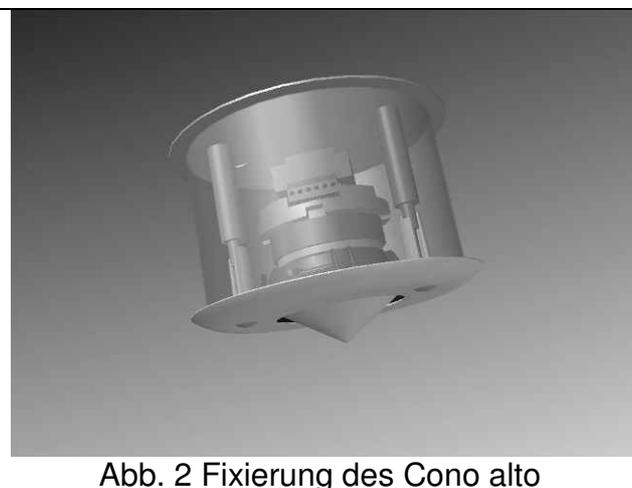
Die NewTec Unterputzdose besteht aus verzinktem Blech. Sie wird direkt in die Decke bei dessen Erstellung eingegossen. Anschließend wird der Cono alto angebracht (Abb.2), indem die Befestigungskralen des Cono alto entfernt werden und die 3 Schrauben an den 3 dafür vorgesehenen Halterungen der Unterputzdose verschraubt werden.
